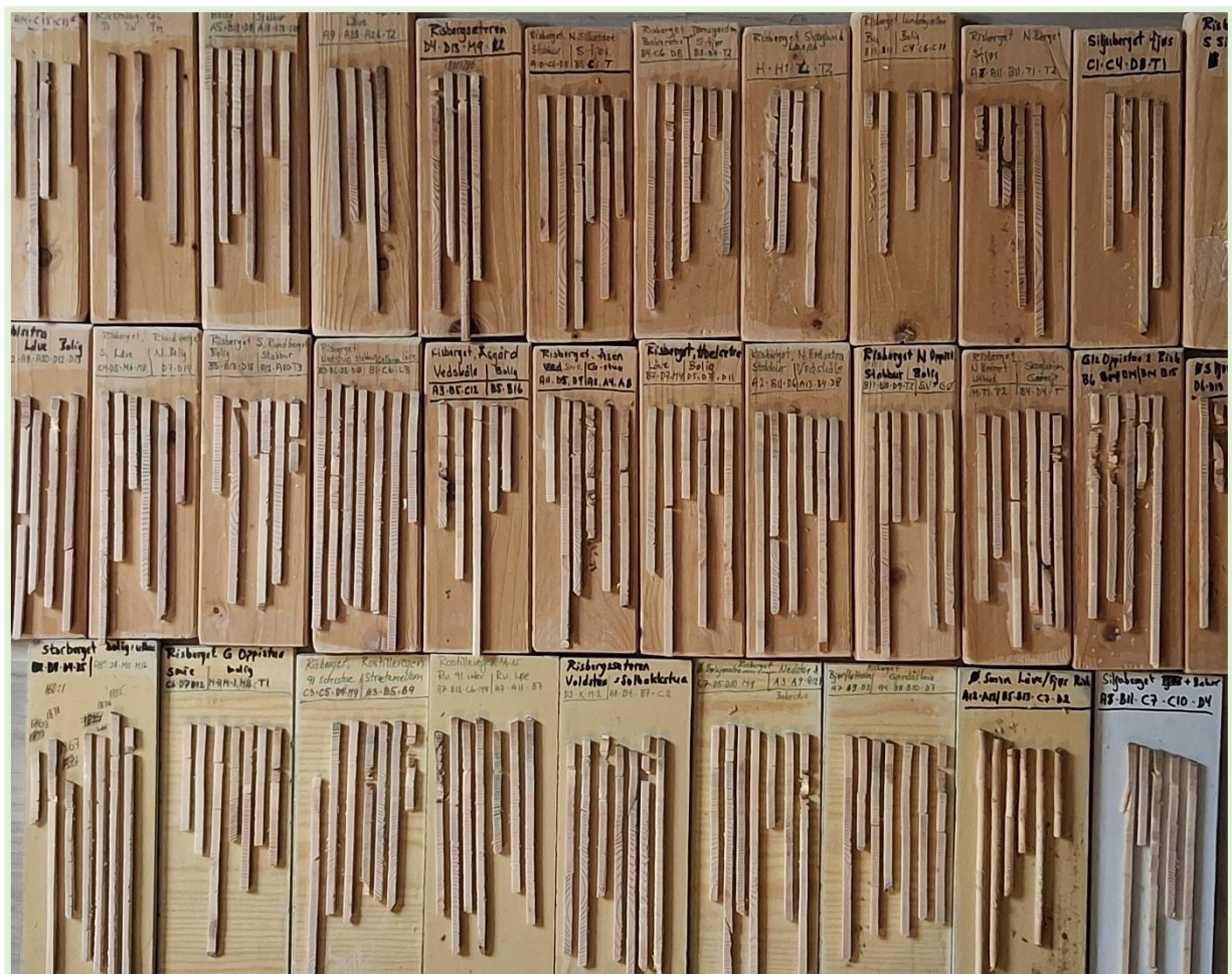
Prøvene blir limt på plater og slipt før det lages en stor forstørrelse med dataskanner, der ringene kan ses og måles. (Prøvene fra Risbergsområdet).
