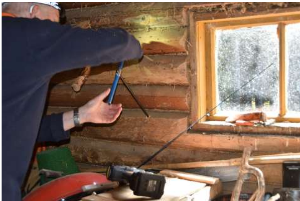
Prøven fra sørveggen var for tørr og gikk i stykker.
